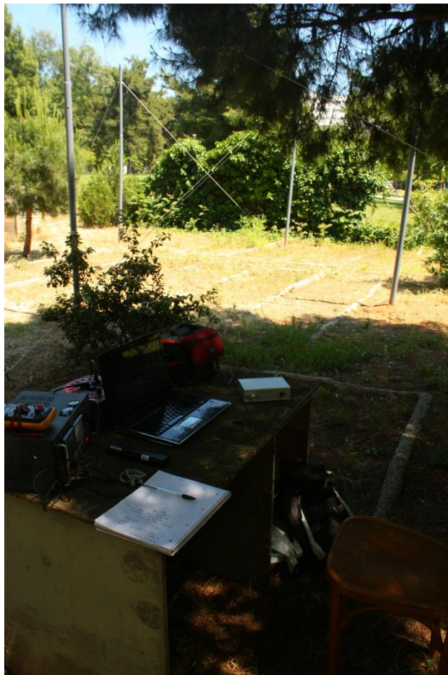
Εικόνα 4.1: Οι πρώτες παρατηρήσεις έγιναν μέσω ενός φορητού σταθμού που στήναμε δίπλα στην κεραία κάθε φορά που θέλα με να παρατηρήσουμε.
