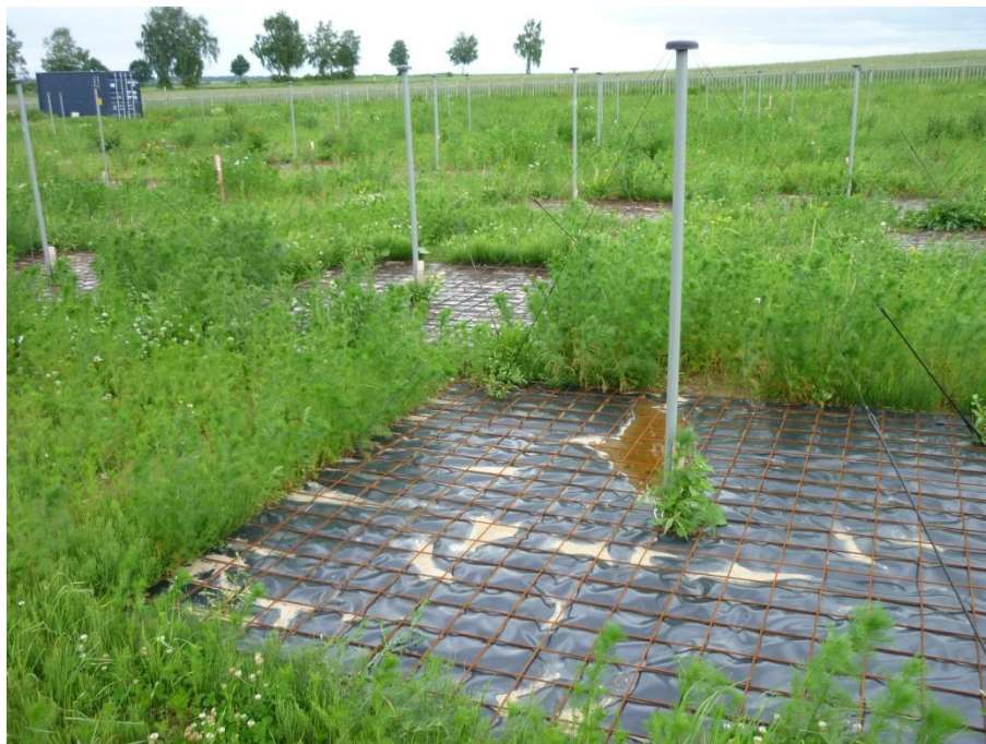
Εικόνα 1.4: Μία κεραία-δίπολο της μπάντας χαμηλών συχνοτήτων του προγράμματος LOFAR.
